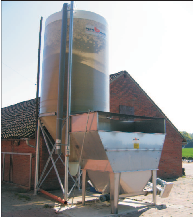
CCM-Beschicker mit Austrageschnecke und Polyester-Außensilo
