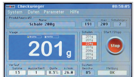
Bildschirm des Bediengeräts mit Anzeige der aktuellen und der letzten sieben Wiegungen und weiterer Produkt-Informationen.
