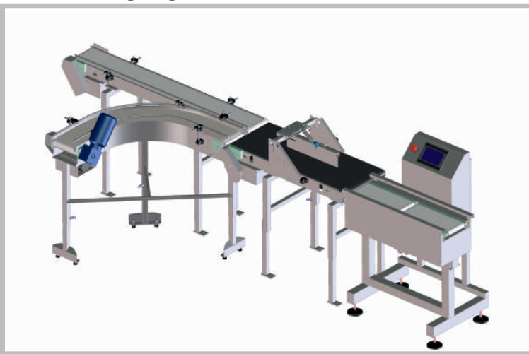
Aufbau-Beispiel mit Kontroll-Waage, Aussortier-Weiche und Transportbändern.
