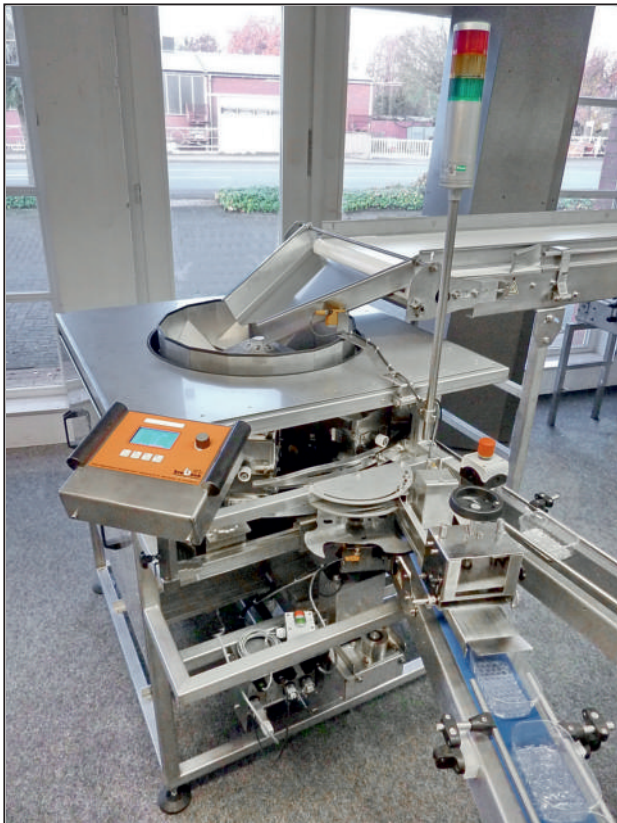
Dosieranlage ADS 70/8 Karussell
