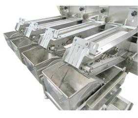
Die ADS 200/4 Dosieranlage verfügt über vier Dosierarme zur Befüllung von Schalen mit Blaubeeren oder ähnlichen Produkten. Über ein Zuführband, z.B. ein Inspektionsband, werden die Beeren zunächst auf einen Querverteiler geleitet, der für eine gleichmäßige Verteilung auf die vier Dosierarme sorgt. Schmale Dosierbänder fördern dann die Beeren in Wiegekammern, die sich bei Erreichen des Zielgewichts über Drehklappen öffnen.
