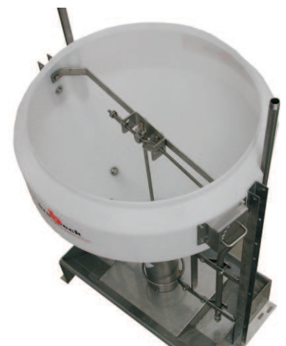
Trichter mit Rührwerk Drehpendelrohr / Futtertisch
