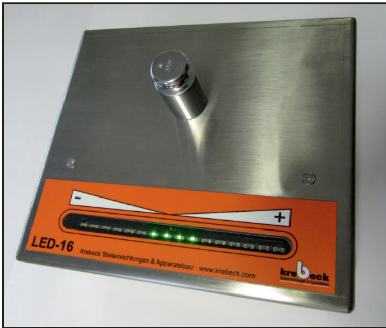
LED Anzeige bei Nullstellung
