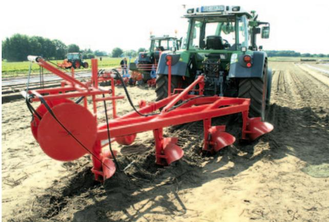
Mit dem T-Tape Pflug der Schröder Landmaschinen KG können nach der Erdbeerkultur die Tropfschläuche entfernt und die Fläche zugleich einmal bearbeitet werden
