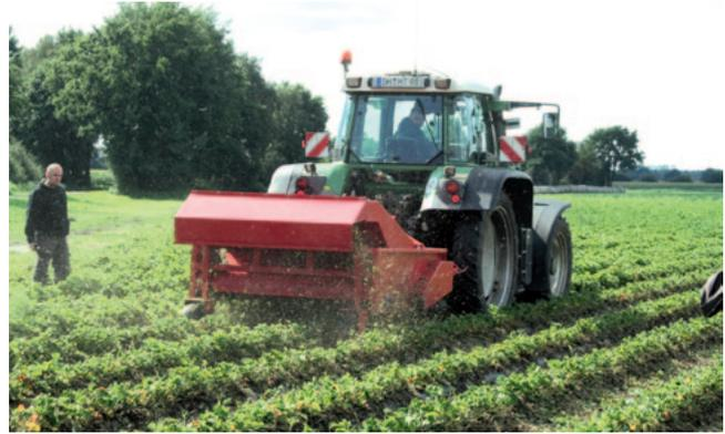
Der Erdbeer-Entracker der Firma Böckenhoff Folien GmbH kann mit 8–10 km/h über zwei Dämme gleichzeitig gefahren werden
